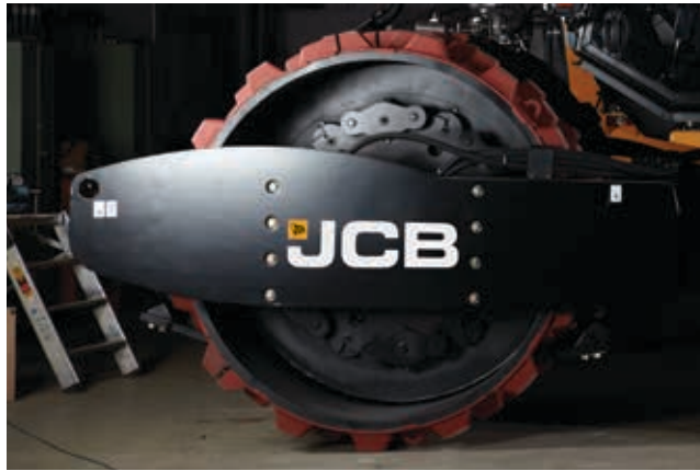
Schneller und einfacher Anbau der Stampfußschalen-Segmente (3 Segmente). Rüstsatz inklusive Abstreifer.
