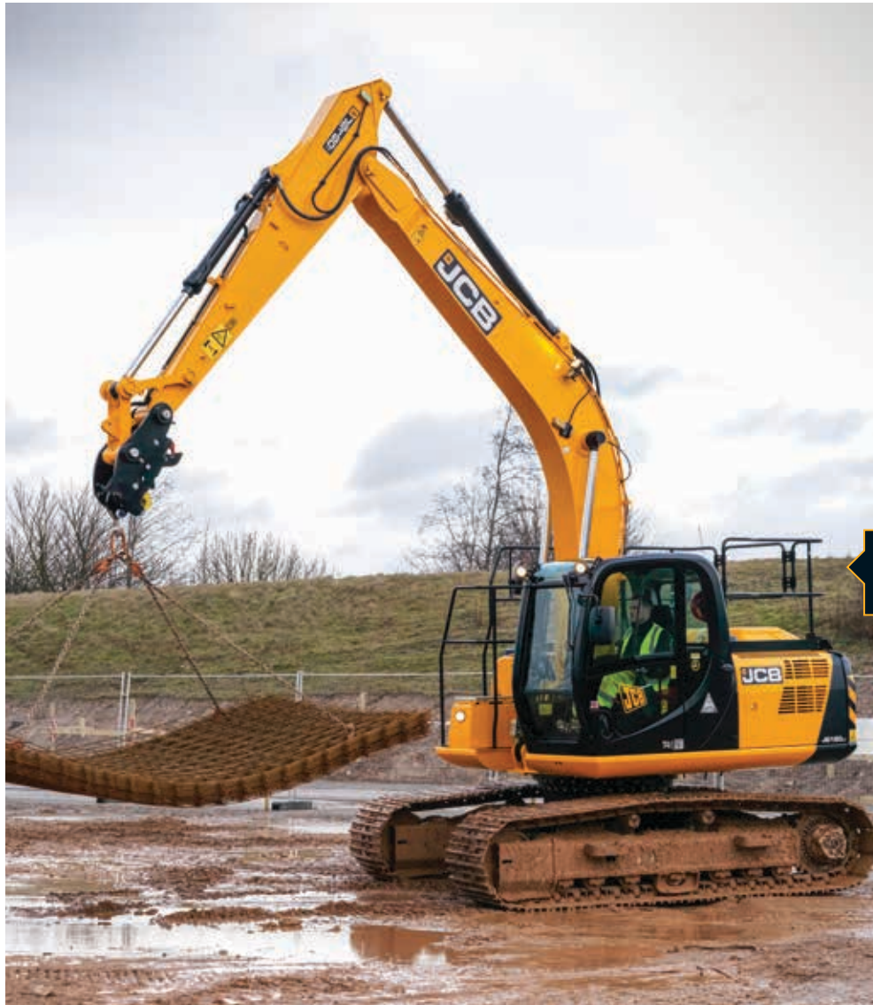
Der Drehturm des JCB JS160/180/190 ist unten und oben mit dem Unterwagen verschweißt.
